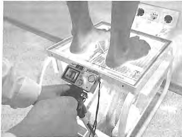
Рис. 6.12. Проведение обследования на аппаратно-программном комплексе «Плантовизор». Осуществляется цифровая фотосъемка плантарной поверхности стоп с последующей обработкой в компьютерной программе с корреляционными коэффициентами, что позволяет получить графико-математические показатели стопы
