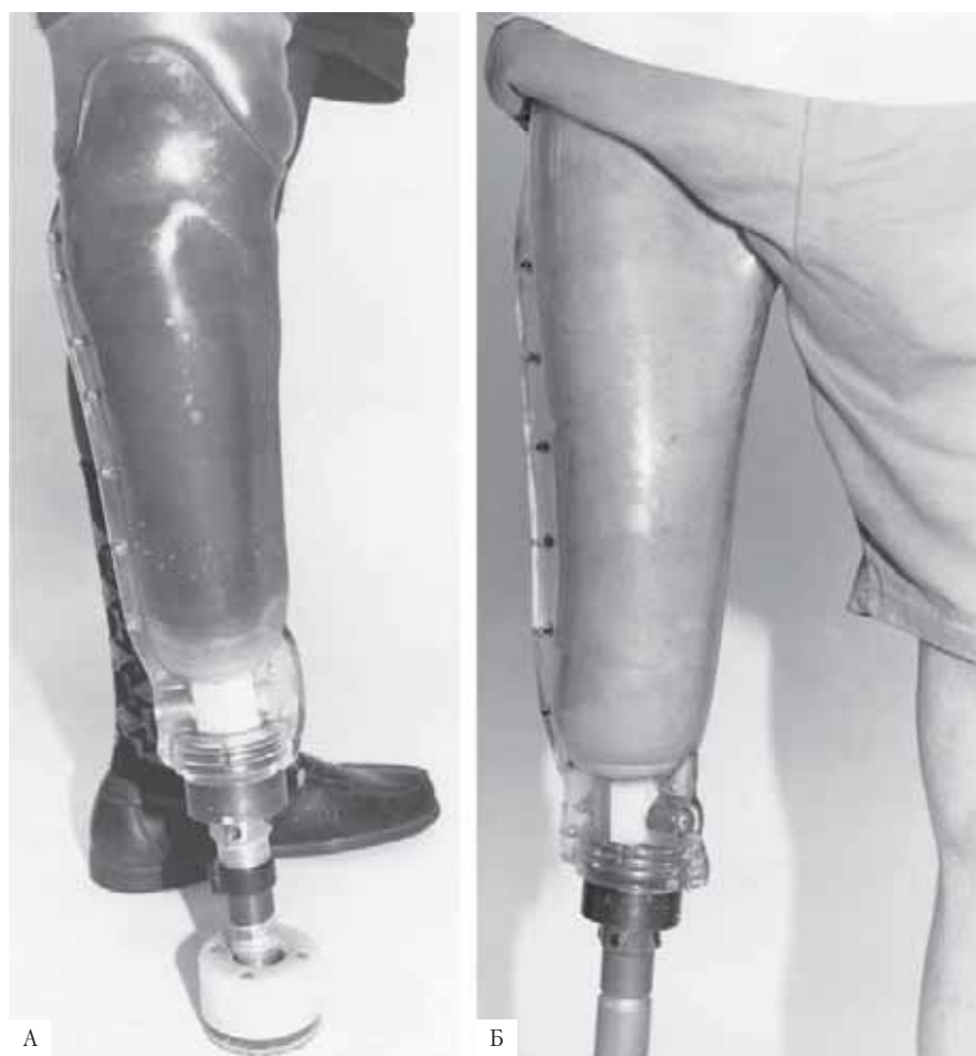
Рис. 100.13. (А) Статический биомеханический анализ тестовой гильзы протеза голени. (Б) Статический биомеханический анализ тестовой гильзы протеза бедра.
